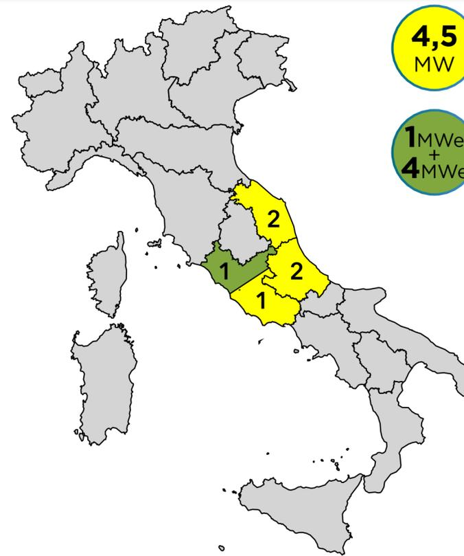
Gli impianti fotovoltaici sono localizzati nelle regioni: Lazio, Abruzzo e Marche e hanno una potenza installata di 4,5MWe. L'impianto alimentato a biomasse legnose è localizzato nella regione Lazio ha una potenza installata di 1MWe + 4MWe.
